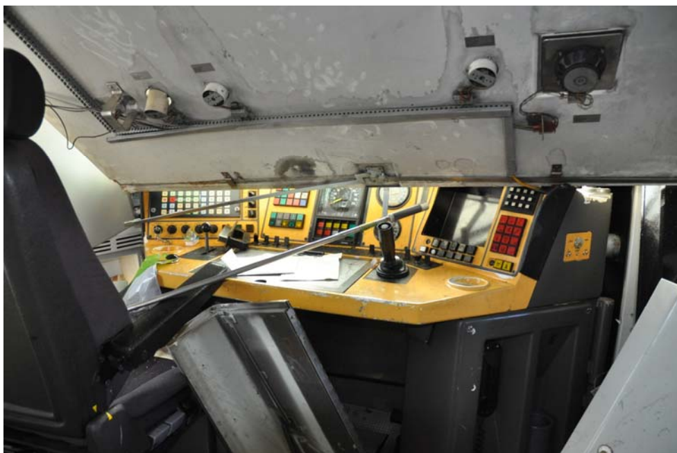
Foto 14 Skader i førerrummet MF 5037
