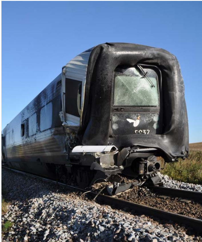
Foto 3 Skader på fronten af MF 5037
