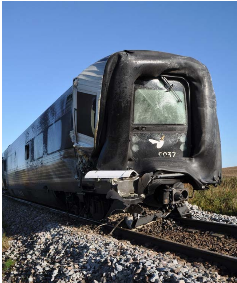
Foto 9 Den skadede front og undervogn på MF 5037
